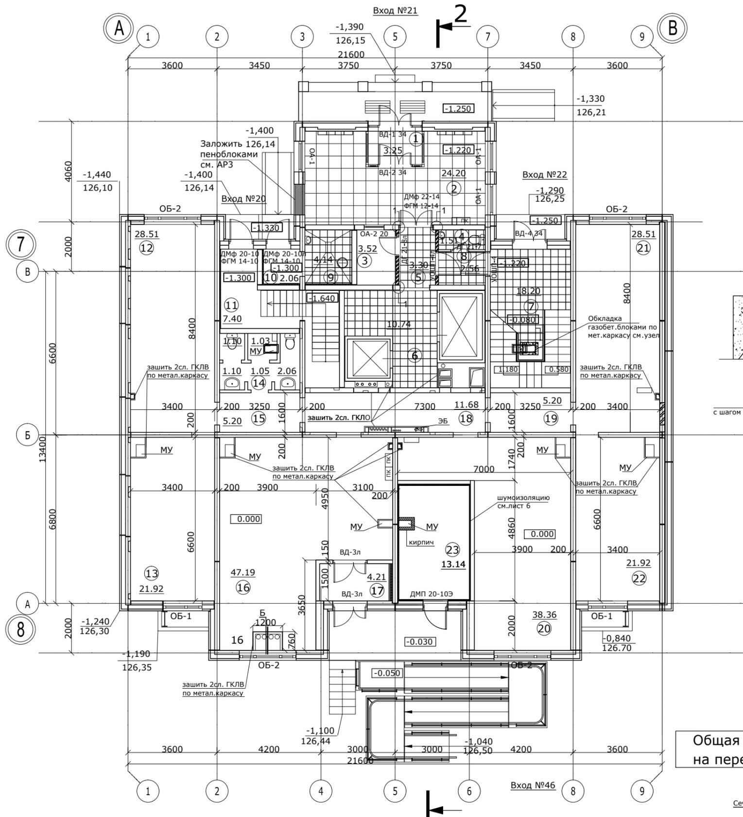
Общая расчетная полезная нагрузка на перекрытие составляет не более 800кг/м<sup>2</sup>
